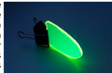
Fluoreszenzkollektor aus Plexiglas und Farbstoff aus einem Textmarker
