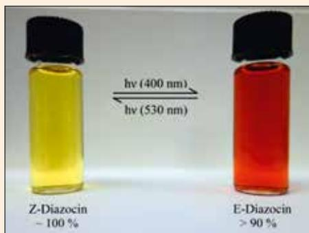
Abb. 4: Z-E-Isomerisierungen von Diazocin (links Z-, rechts E-Isomer)
