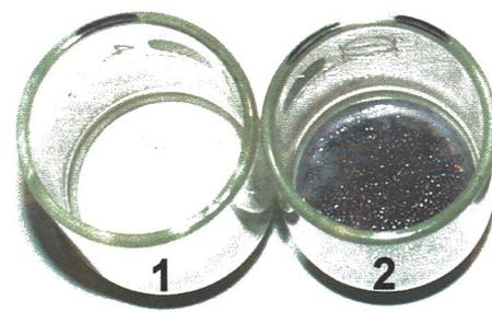
Abb. 3: Mit Kaliumiodid/Stärke-Lösung versetztes frisches Titandioxid (1) und Titandioxid nach der Bestrahlung in V1
