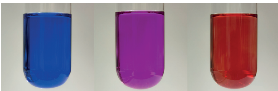
Abb. 9: Solvatochromie von Merocyanin in Xylol, Aceton und Ethanol
