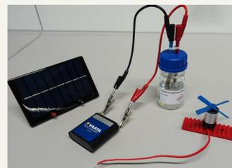
Abb. 5: Einfache alkalische Brennstoffzelle.
