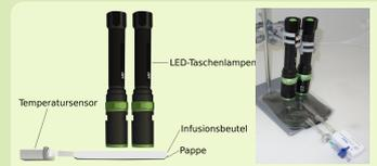
Abb. 2: Beschriftete Versuchsskizze und Foto des Versuchsaufbaus. [3]
