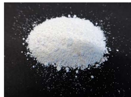
Abb. 1 Nanoskaliges Titandioxid-Pulver, P25
