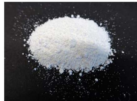
Abb. 1 Nanoskaliges Titandioxid-Pulver, P25
