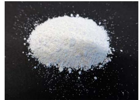
Abb. 1 Nanoskaliges Titandioxid-Pulver, P25
