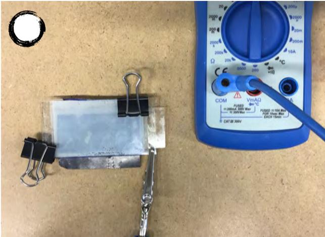
Klemme das blaue Kabel mittels Krokodilklemme am Glasrand der Photoelektrode an.
