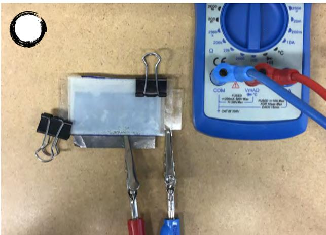
Klemme das rote Kabel mit der Krokodilklemme an die Graphitfolie an.
