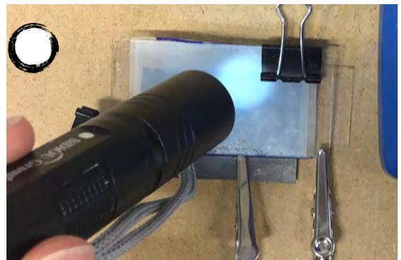
8. Befestige die zweite Krokodilklemme am Glasrand der Photoelektrode.
