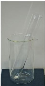
Wiegen Sie 50 mg des  $\text{TiO}_2/\text{Pt}$ -Katalysators in einem großen Reagenzglas ab.
