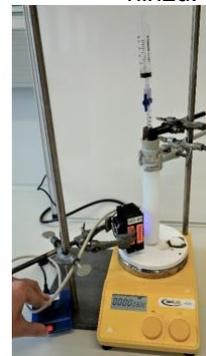
Schalten Sie die Magnetrührplatte (mind. 300 U/min) und die Highpower-LEDs (365 nm) zur Bestrahlung der Suspension ein (mind. 30 min).
