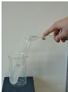
Geben Sie eine Ethanol-Lösung ( $c = 1 \text{ mol/L}$ ) zum Katalysator hinzu und füllen Sie das Reagenzglas bis etwa 2 cm unterhalb des Randes auf.
