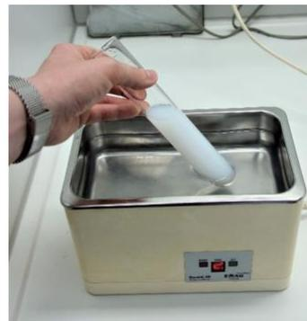
Tauchen Sie das Reagenzglas mit der Suspension für 3 Minuten in ein Ultraschallbad.
