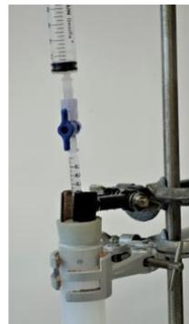
Spannen Sie eine weitere Klammer unmittelbar über dem Stopfen ein, sodass dieser fest auf den Reagenzglas sitzt.
