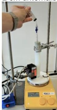
Spannen Sie das Reagenzglas mit dem befestigten Aufsatz über einer Magnetrührplatte ein. Setzen Sie eine 10-mL Spritze auf. Der Stempel der Spritze sollte nach unten gedrückt sein.
