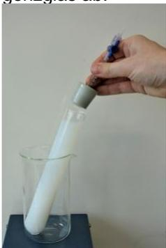
Verschließen Sie das Reagenzglas mit einem durchbohrten Stopfen, in den eine 1-mL Spritze mit aufgesetztem Zweiwegehahn gesteckt ist.
