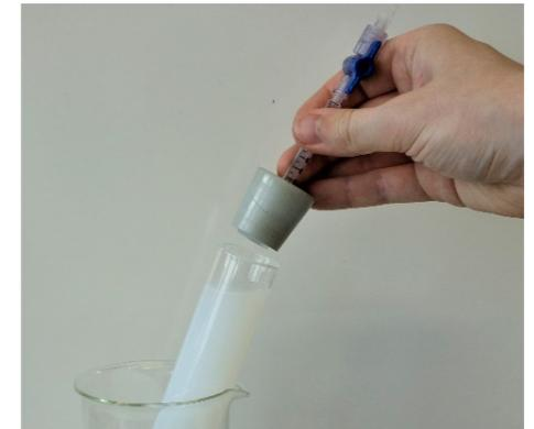
Schritt 5 Spannen Sie das Reagenzglas mit dem befestigten Aufsatz in eine Stativklemme auf einer Magnet-rührplatte ein.
