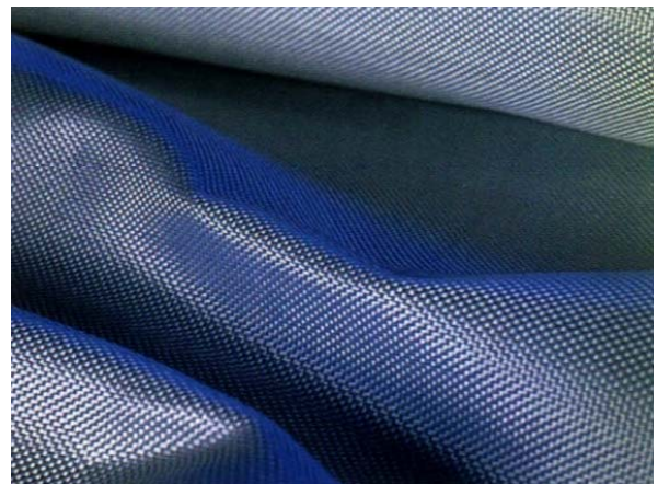
Siliconbeschichtetes Gewebe des Airbags
